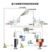
智能密度控制系统是一种应用于煤炭洗选工艺的智能控制技术,旨在实现煤炭产品的准确密度控制和优化生产过程。
